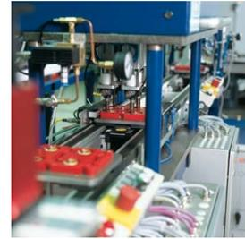
Fabricación completamente automatizada de manómetros pequeños
